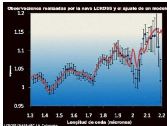
**Derecha, arriba:** Datos obtenidos mediante el espectrómetro de infrarrojo cercano de la nave LCROSS, tomados de 20 a 60 segundos después del impacto del cohete de impulso Centaur. La curva corresponde a un modelo que contiene agua y otros compuestos (algunos de los cuales continúan sin identificación). Un modelo ajustado que contiene únicamente agua se puede hallar [aquí](#). Crédito: NASA
