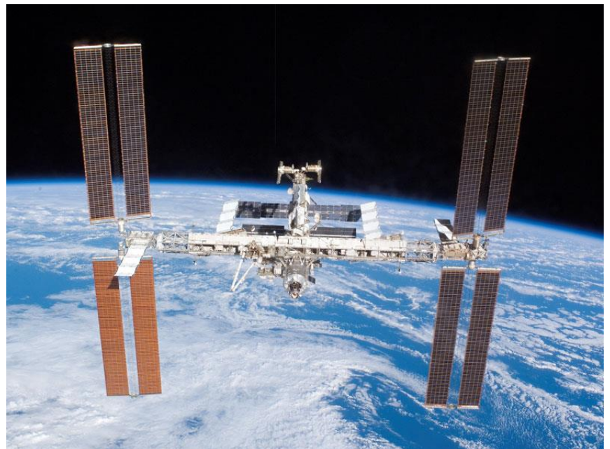
Fig. 9: La ISS orbita a 400 km de altura a 7.66 km/segundo y orbita 15.56 veces alrededor de la Tierra en un día.
